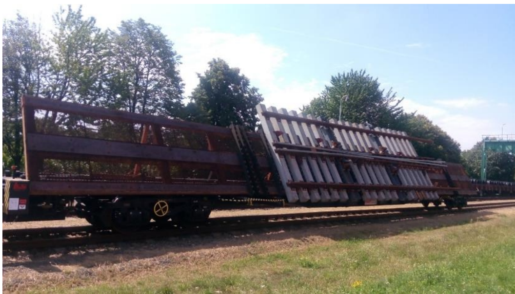
Obrázek 14 - Speciální vagón ZPV-01 se srdcovkovou částí 1:26,5 s několika demontovanými pražci
