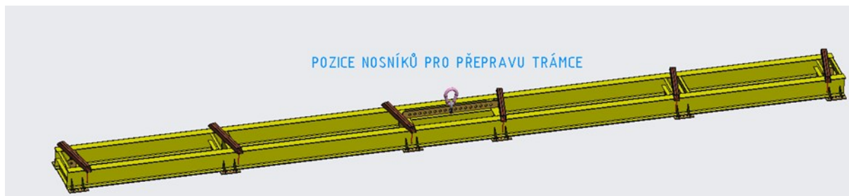
Obrázek 18 - Pozice nosníků pro přepravu trámce
