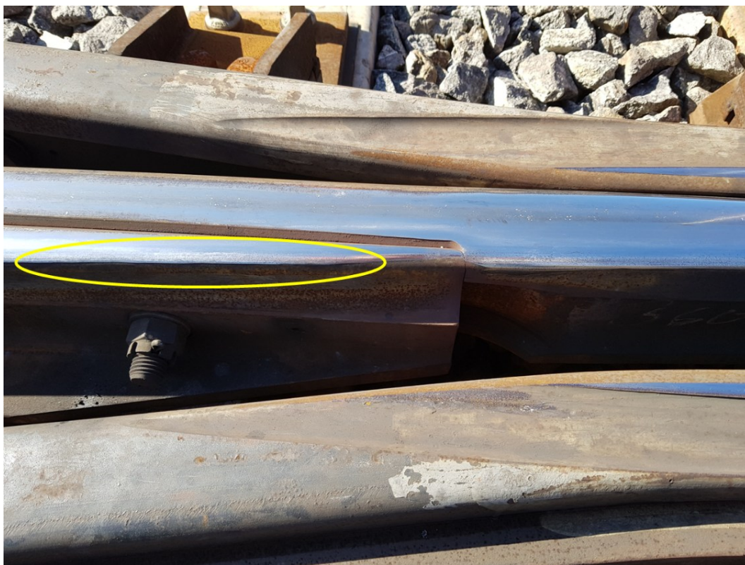
Obrázek 22 - Převalky na pohyblivém hrotu
