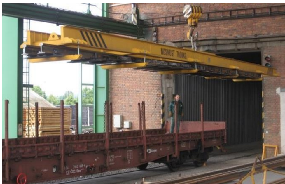
Obrázek 17 - Příklad dodávky srdcovky s PHS 1:26,5 v transportním trámci
