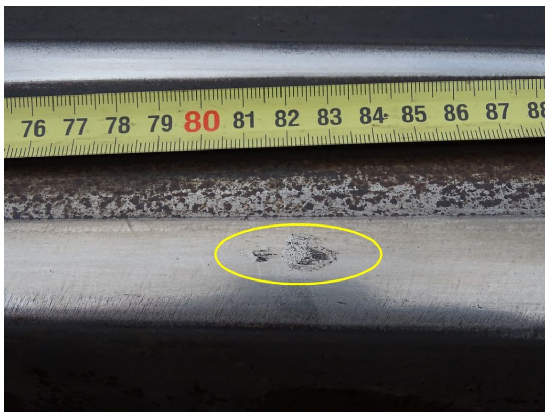
Obrázek 24 - Povrchové vady na hrotu srdcovky s PHS vzniklé prokluzem kol
