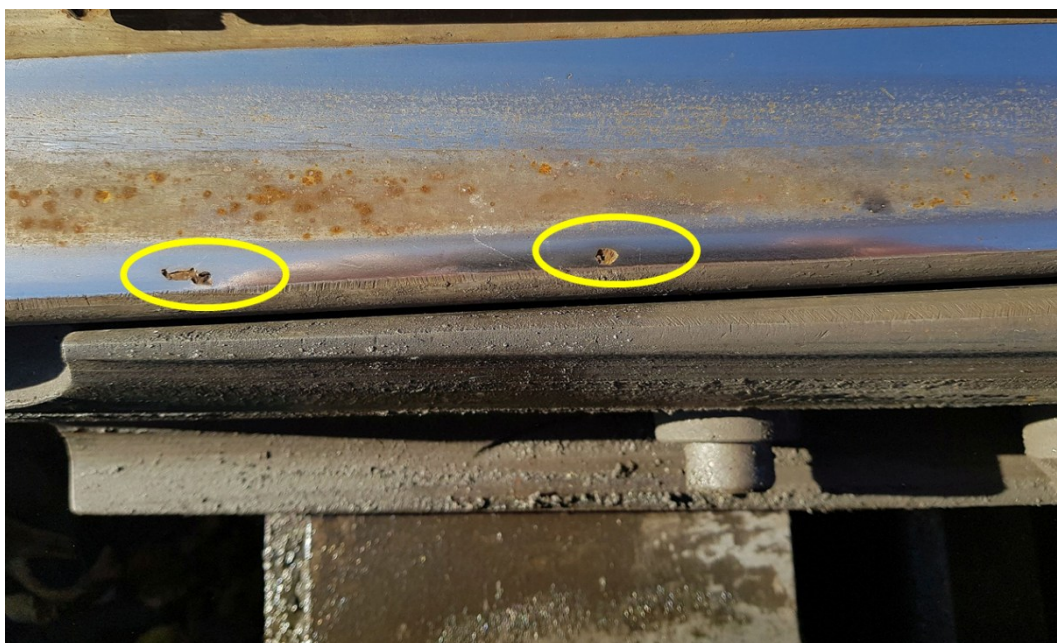
Obrázek 26 – Kontaktně únavové vady na pojížděné ploše odlévaného rámu srdcovky s PHS
