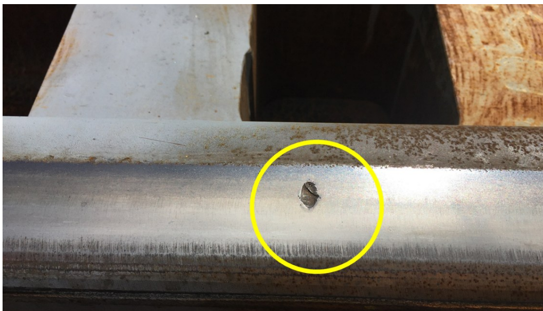
Obrázek 25 – Kontaktně únavové vady v kořeni srdcovky s PHS
