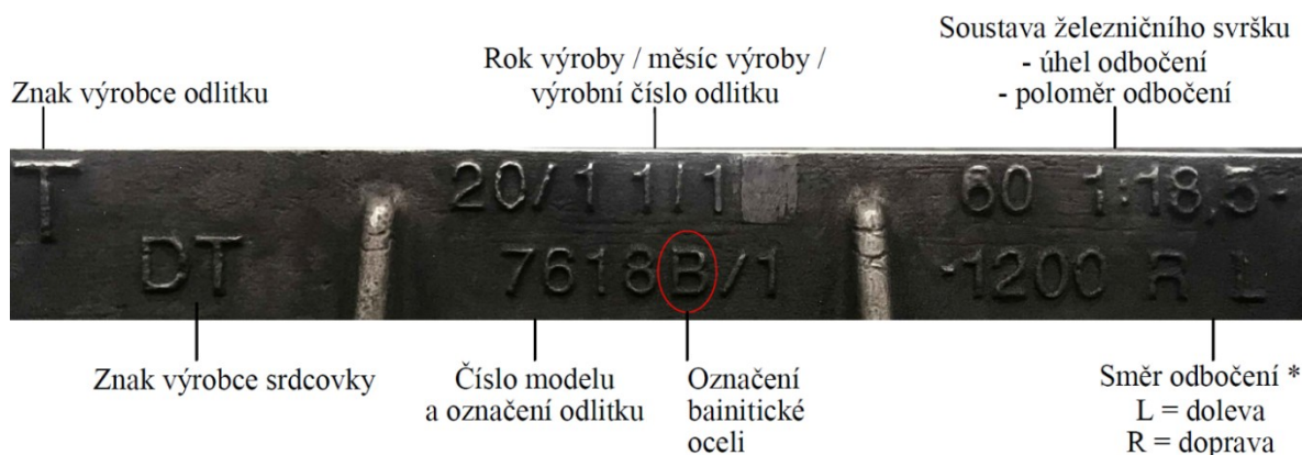
Obrázek 10 - Příklad označení odlitku srdcovky
